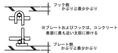
註) プレートおよびフックのかぶり確保により、曲げ材の有効せいdに影響の可能性があるので、その影響を検討すること。
