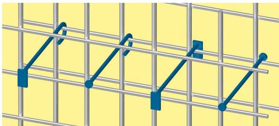
図 2.1 Head-bar を面部材に使用する場合の形状および組立て状況
